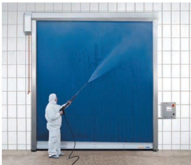
SRT-EC ステンレス製で水はけ構造となっている為、 ドア全体を丸洗いすることが可能です。 強靱なシートは高圧洗浄の水圧でも問題はありません。 精肉工場、水産工場等に適したドアです。
