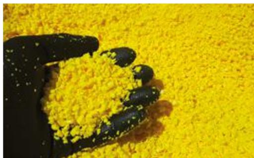
ボープランでは生産時に発生した端材を回収し、新しい製品を製造するための補助原料としてリサイクルしています
